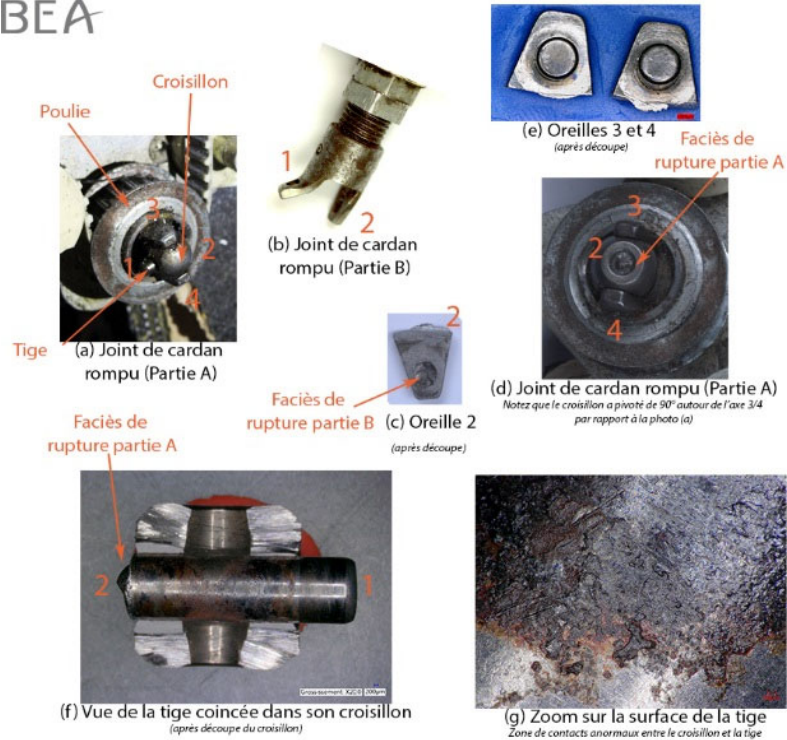
Figure 2 : Examen du joint de cardan côté gauche
