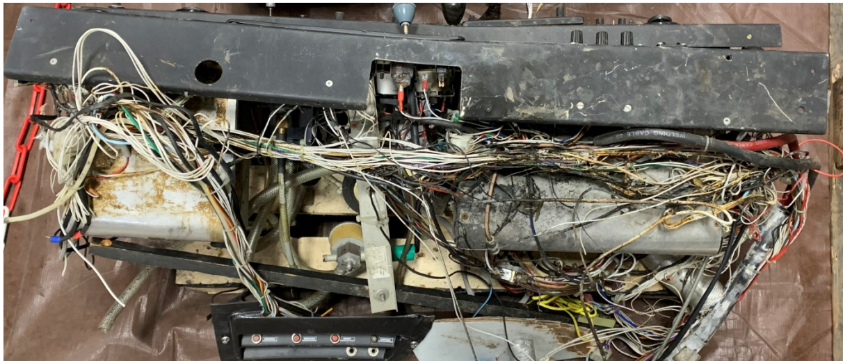
Figure 1 : arrière de la planche de bord et répartition des traces d'échauffement (Source : BEA)
